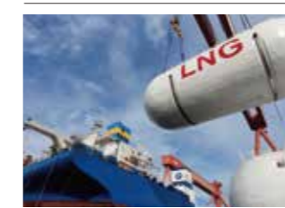
公司建造的全球首制双燃料散货船H1531船液化气罐成功吊装。
